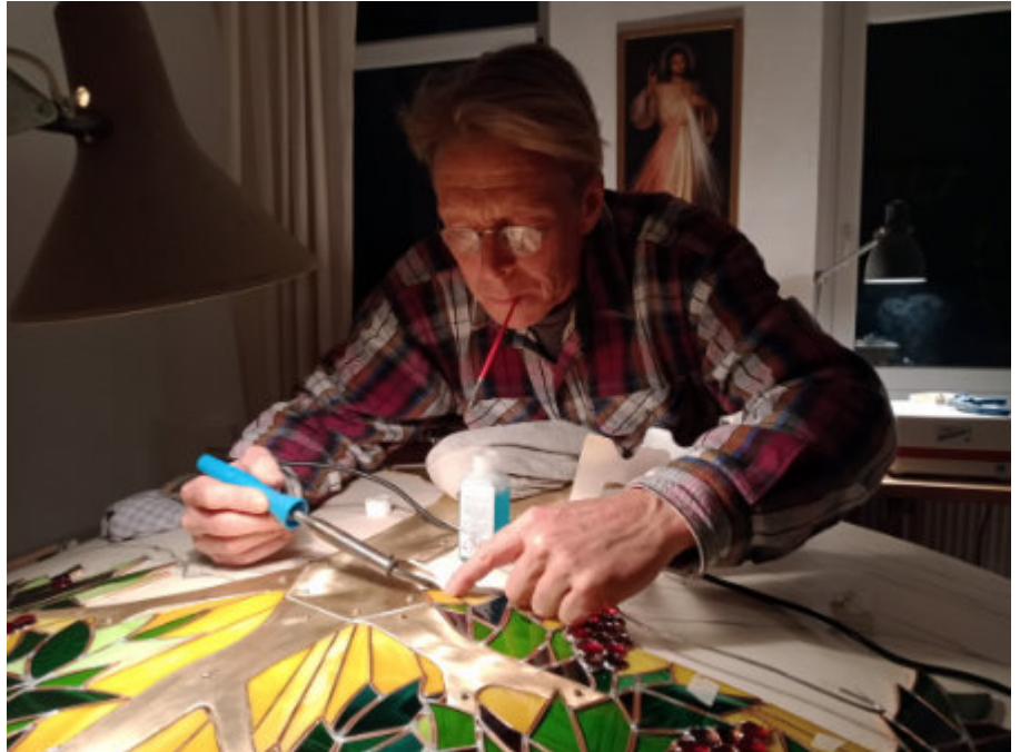
Verlötung der einzelnen Glaselemente
