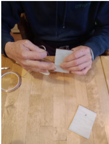
Ummantlung der einzelnen Glaselemente mit Kupferband für die anschließende Verlötung
