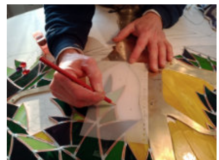
Für jedes einzelne Glaselement wird eine Schablone aus Transparentpapier angefertigt.
